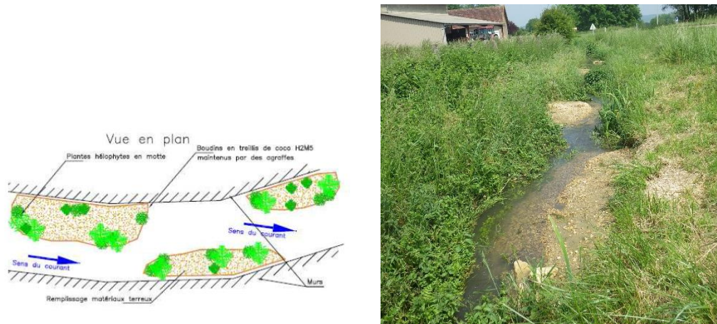
Figure 29: Schéma de principe de banquettes alternées- Réalisation de banquette
