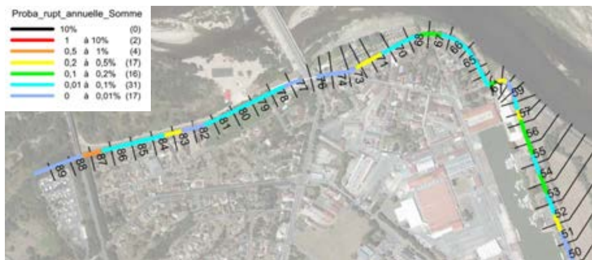
Figure 113 : Cause de défaillance sur la levée de la Blanchisserie (fond de carte : somme des probabilités de rupture annuelles)
