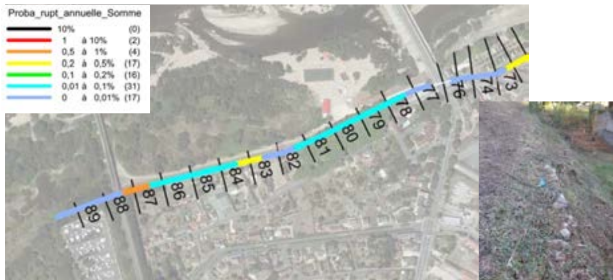
Figure 114 : Cause de défaillance sur la levée du Plateau de la Bonne Dame (fond de carte : somme des probabilités de rupture annuelles)
