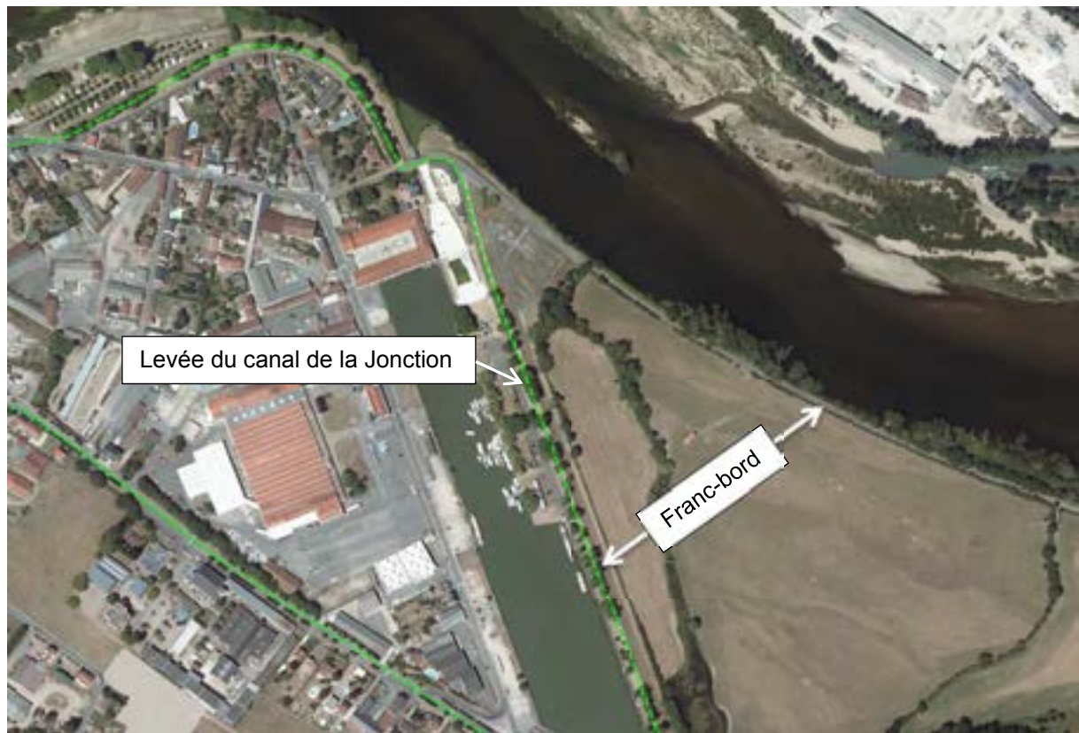
Figure 35 : Illustration du franc-bord au droit de la levée du canal de la jonction (Nevers)
