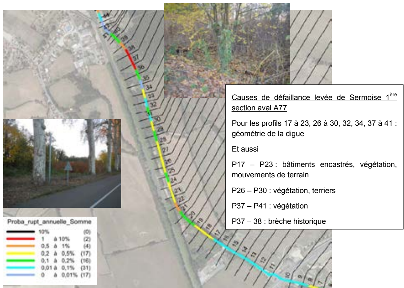
Figure 111 : Cause de défaillance sur la levée de Sermoise 1 ère section aval A77 (fond de carte : somme des probabilités de rupture annuelles)
