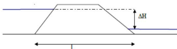
Figure 17 : Schéma de principe pour le calcul du gradient hydraulique de la formule de Bligh
