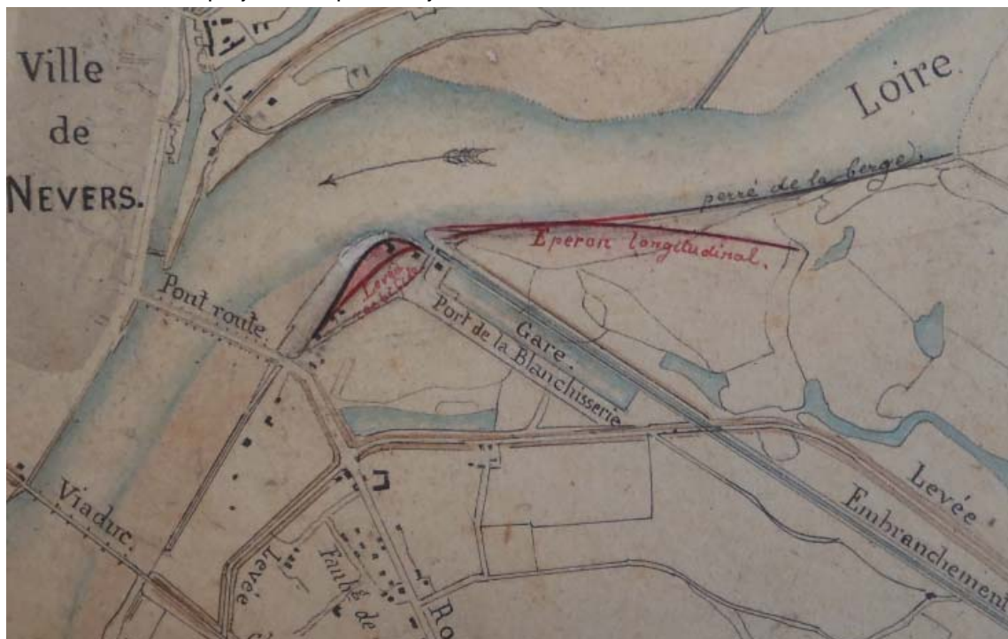
Figure 14 : Projet de rectification de la levée de la Blanchisserie et de mise en place d'un éperon longitudinal – Source : Archives DDT 58
