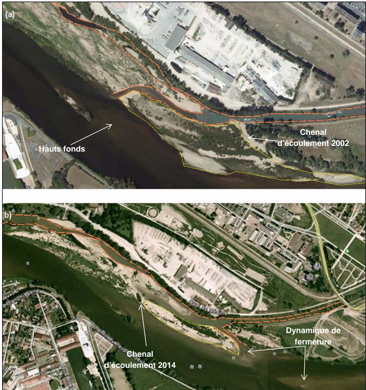
Figure 18 : Comparaison de l'état de l'embouchure de la Nièvre en 2014 (a) et en 2002 (b) - val de Nevers (58) (Géoportail)
