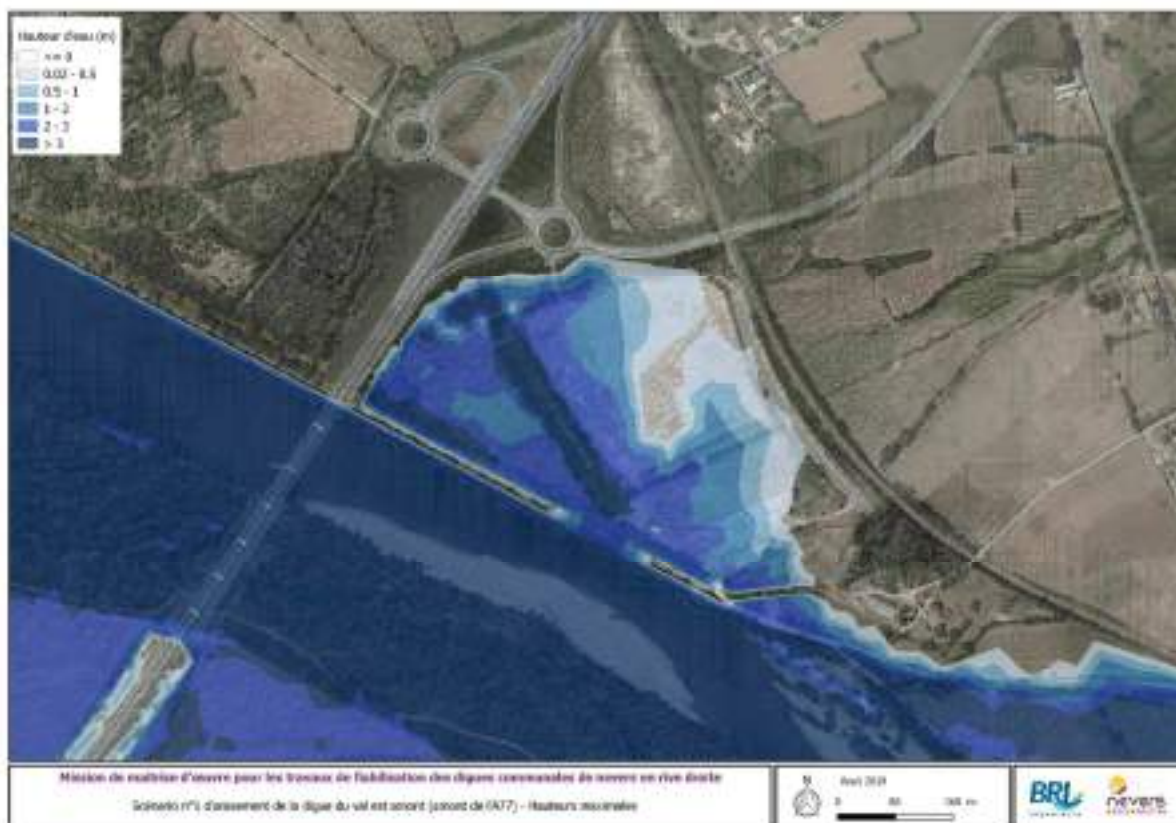
Figure 22 : Carte des hauteurs maximales dans le val Est en amont de l'A77 pour la variante 1 d'arasement de la digue – Crue d'occurrence 200 ans
