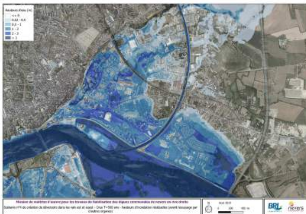
Figure 39 : Carte des hauteurs d'inondations résiduelles (avant ressuyage par d'autres organes) pour le scénario 4 de déversoirs– Crue d'occurrence 500 ans
