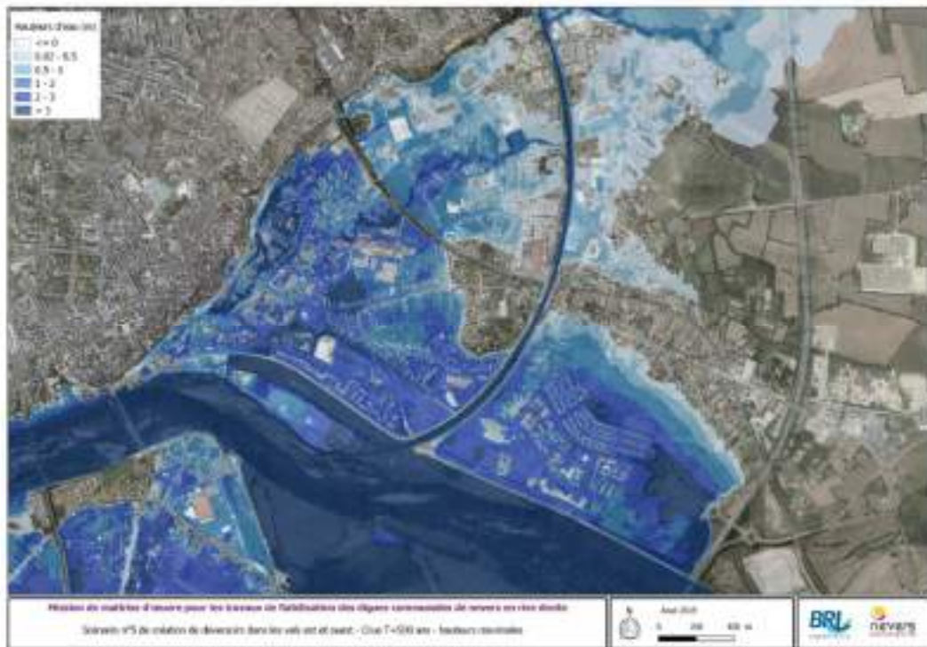
Figure 34 : Carte des hauteurs maximales dans les vals est et Ouest pour le scénario 4 de déversoirs– Crue d'occurrence 500 ans
