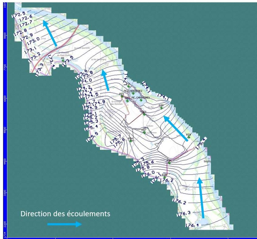
Figure 9-2 : Piézométrie en phase réaménagée (scénario 1)
