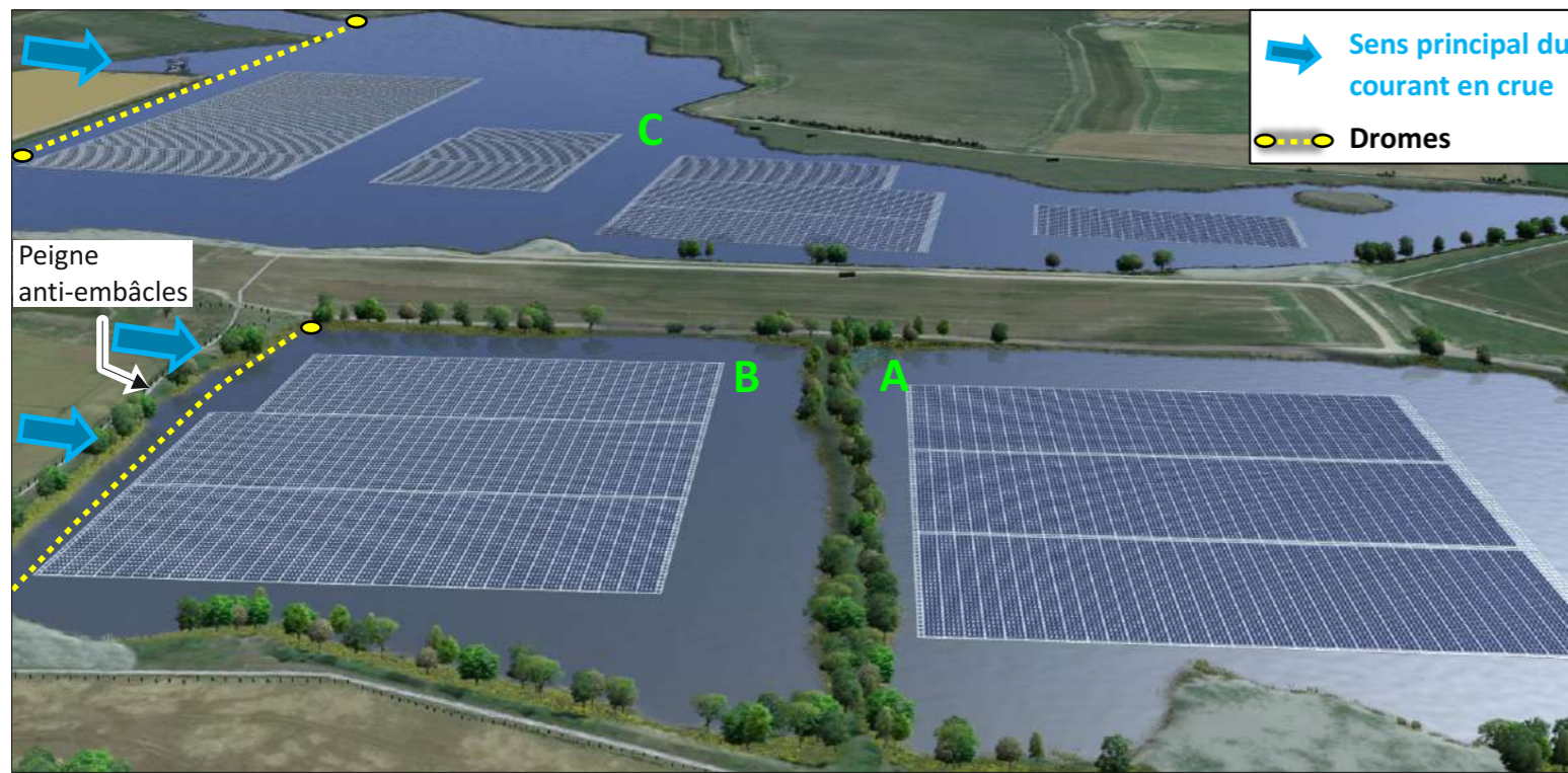
Vue 3D du projet avec localisation des dromes et du peigne anti-embâcles
