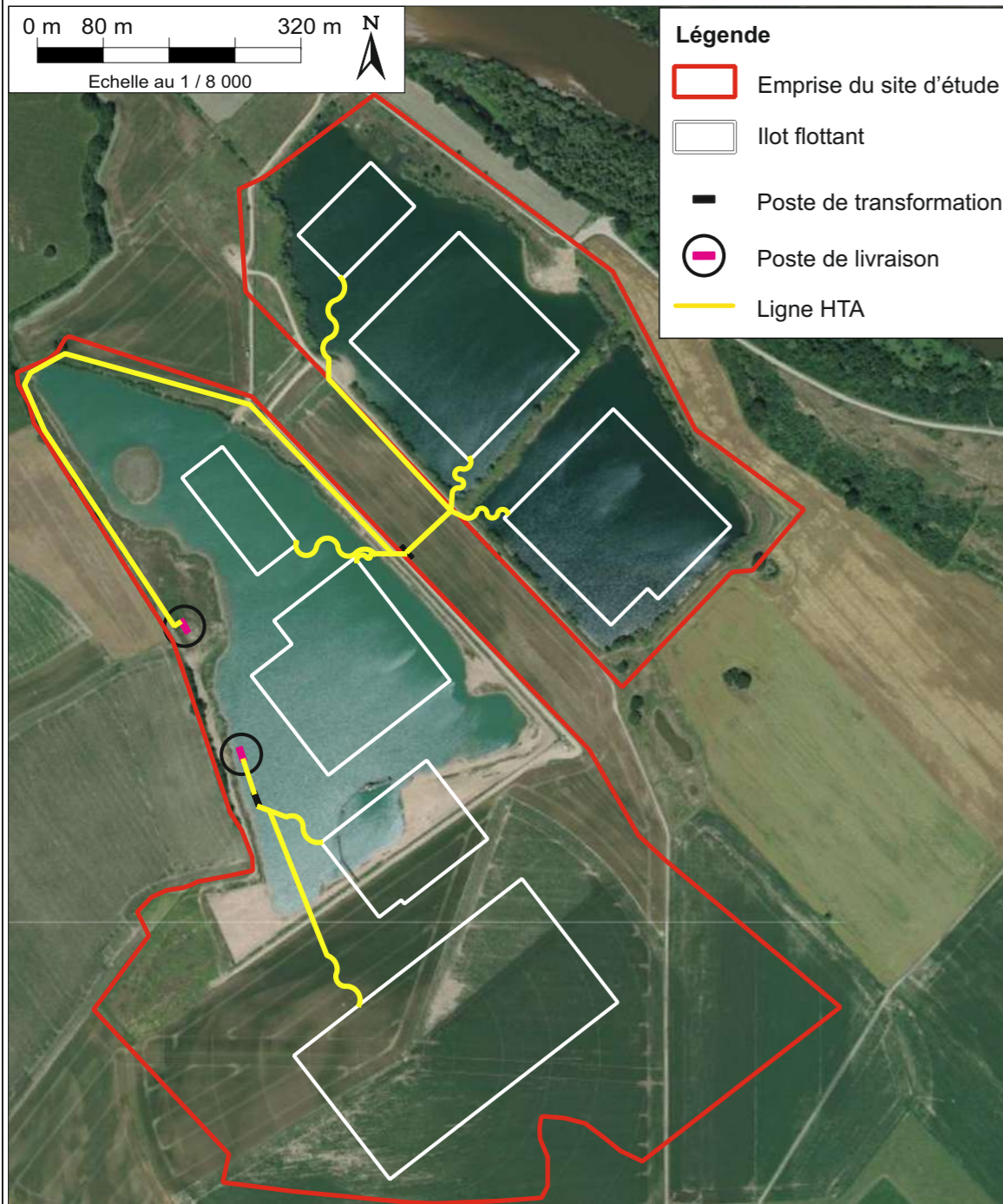
Localisation des postes de livraison
