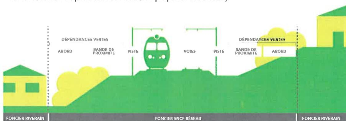
**Sur les voies et pistes**, SNCF Réseau effectue des opérations régulières (sauf exception, 1 à 2 fois par an) de désherbage à l'aide de produits phytopharmaceutiques. Elles sont principalement réalisées par des trains spécifiques appelés « trains désherbeurs » circulant jusqu'à 60 km/h.
