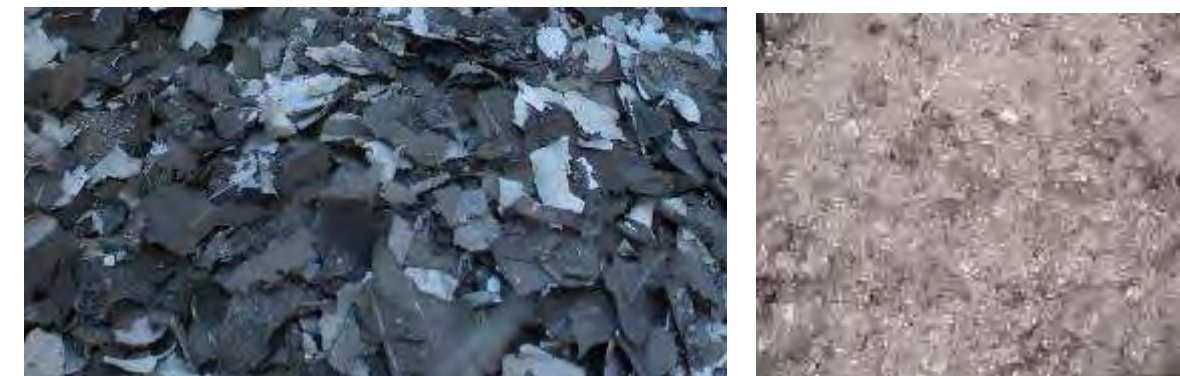
Figure 82 : Fragments de silicium et granulés de verre (source : Pvcycle, 2015)
