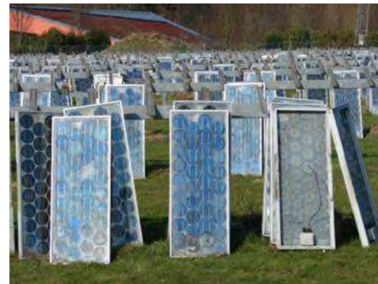
Figure 79 : Panneaux photovoltaïques en fin de vie (source : PV cycle, 2015)
