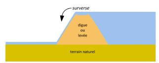
l'érosion régressive de surface par surverse pouvant conduire rapidement, en fonction de la hauteur et de la durée des lames de crues, à la ruine complète de la digue;
