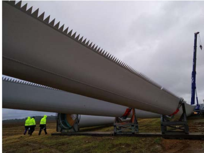
Figure 17 : Illustration de serrations sur éolienne Nordex, Source : Nordex
