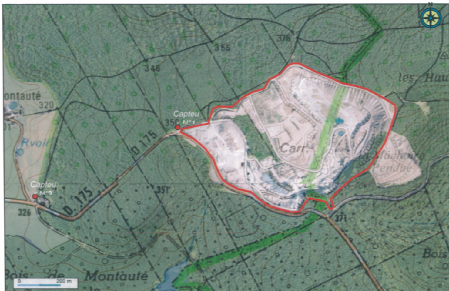
Figure 10 : Plan de situation des appareils de mesure des vibrations
