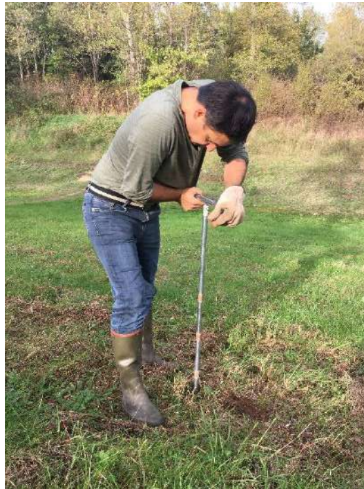
Photo 22 : Réalisation d'un sondage sur la digue de Maison Neuve (in situ IEA/Nevers Agglomération)
