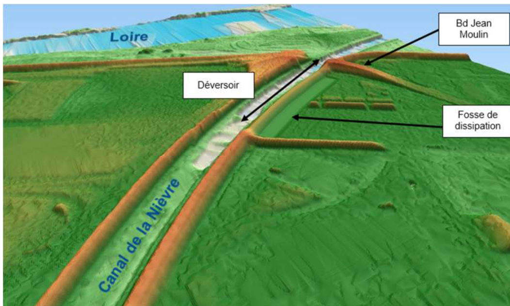
Figure 1-1 : Vue 3D de l'emplacement de la zone de surverse modélisée sous Telemac
