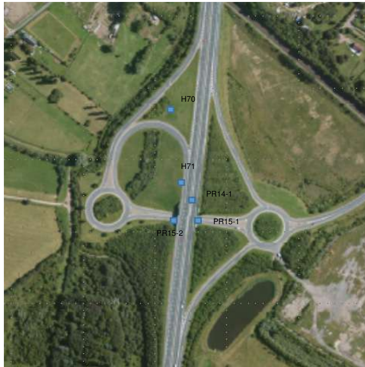
Figure 82 : Implantation des sondages pour les fondations de l'échangeur de l'A77
