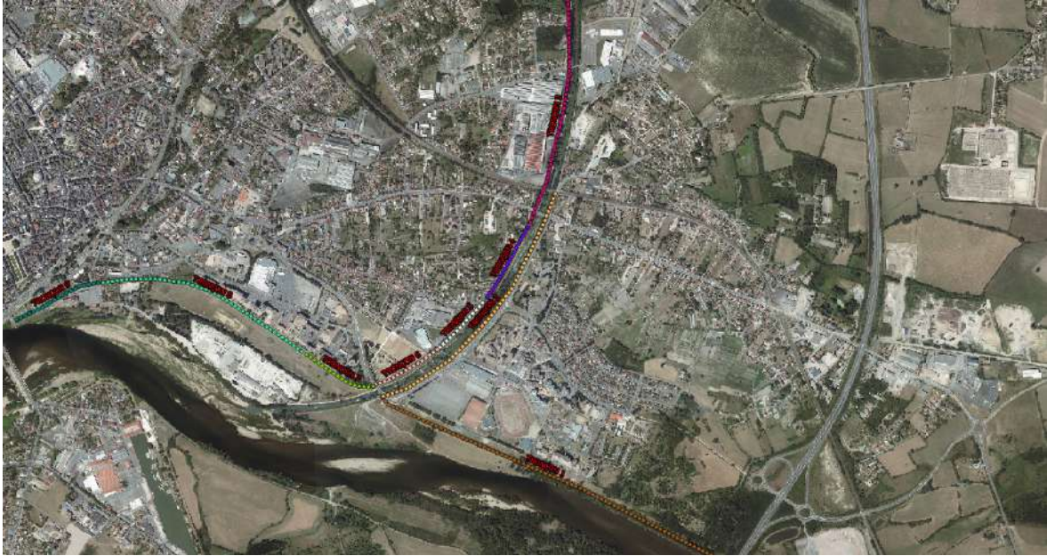
Figure 85 : découpage en tronçons géotechniques homogènes (TR1 à TR9)
