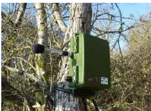
Photo 22 : Détecteur d'ultrasons utilisé lors de l'étude
