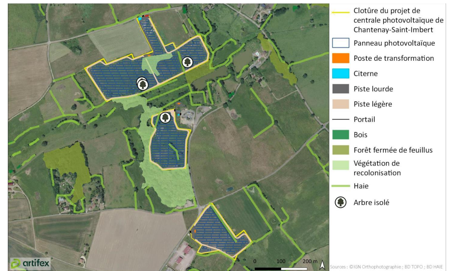
Illustration 120 : Localisation des zones défrichées par la mise en place du projet de centrale photovoltaïque de Chantenay-Saint-Imbert Réalisation : ARTIFEX 2023
