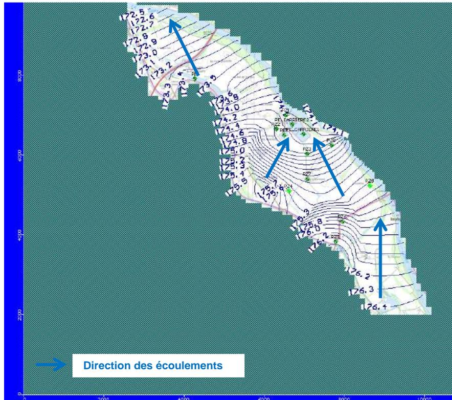
Figure 5-9 : Piézométrie de calage calculée par le modèle
