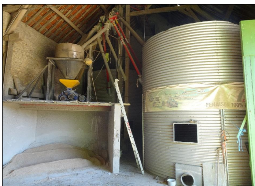
Photographie 8 : Cellules à grains et mélangeuse pour la préparation des aliments dans l'ancien bâtiment en pierres (source : ENCIS Environnement)
