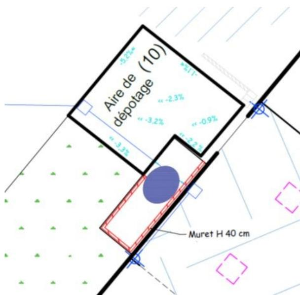
Ainsi, l'aménagement qui sera réalisé permettra de récupérer en cas d'accident le fuel en cas de déversement accidentel.
