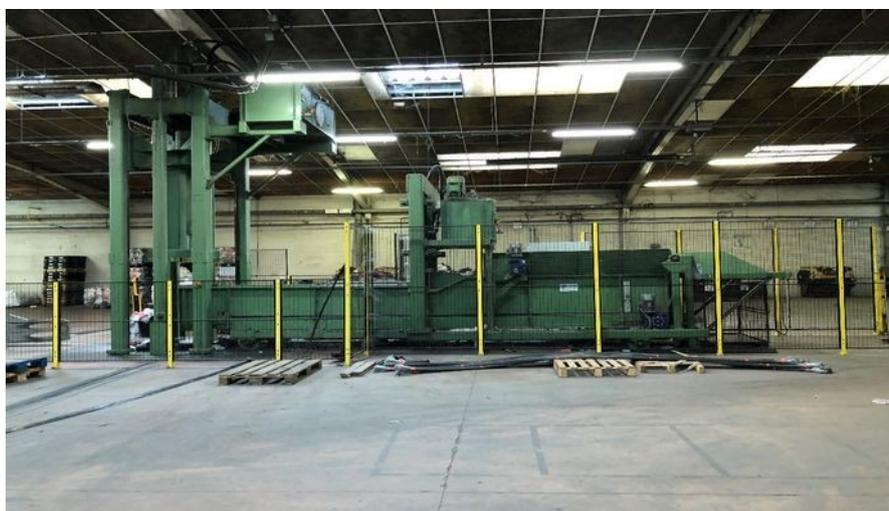
*Illustration 7: ATELIER TRI – Zone n°1 : presse hydraulique pour mise en balle*
