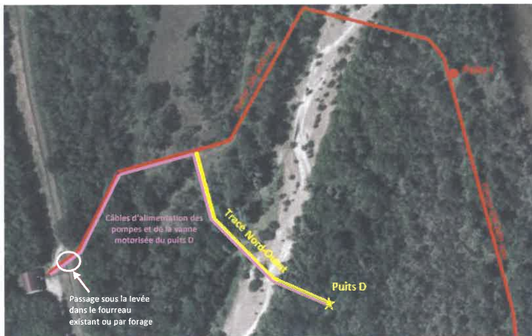
Figure 58 : Alimentation électrique – Tracé nord-ouest
