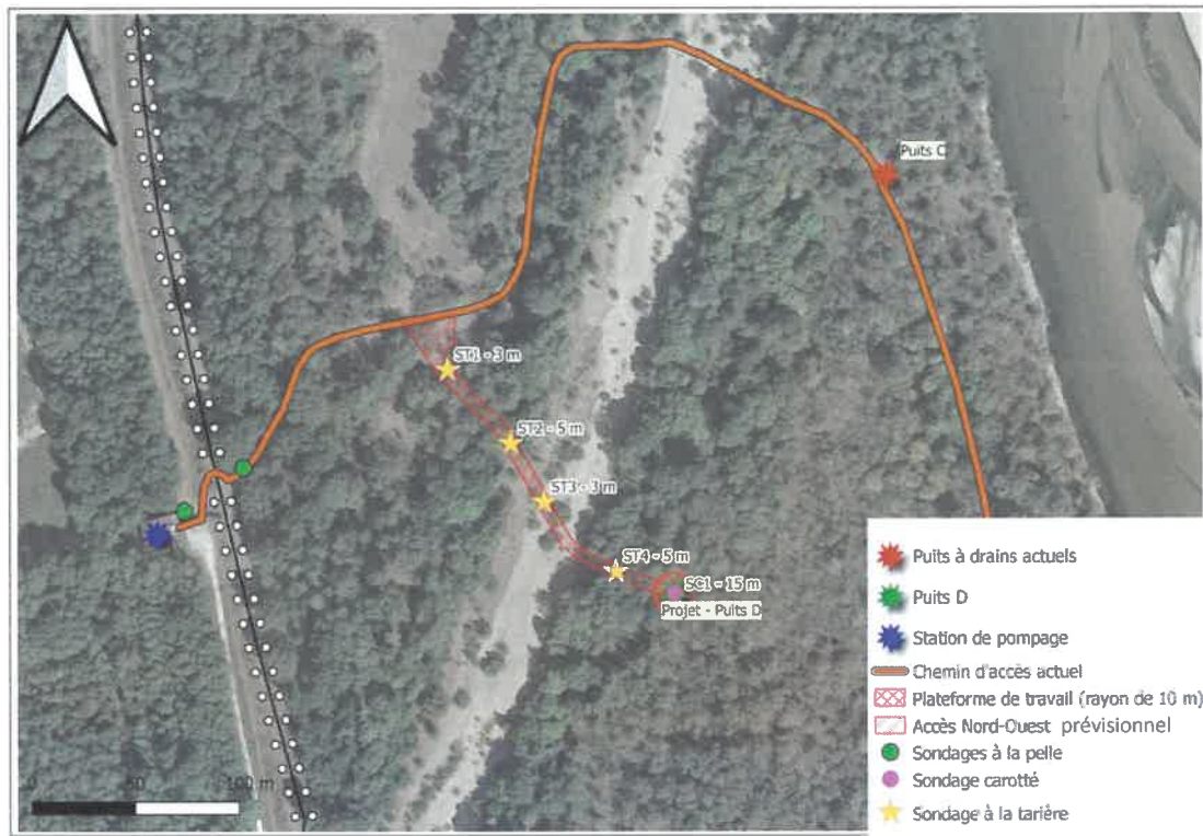
Figure 11 : Localisation des investigations géotechniques
