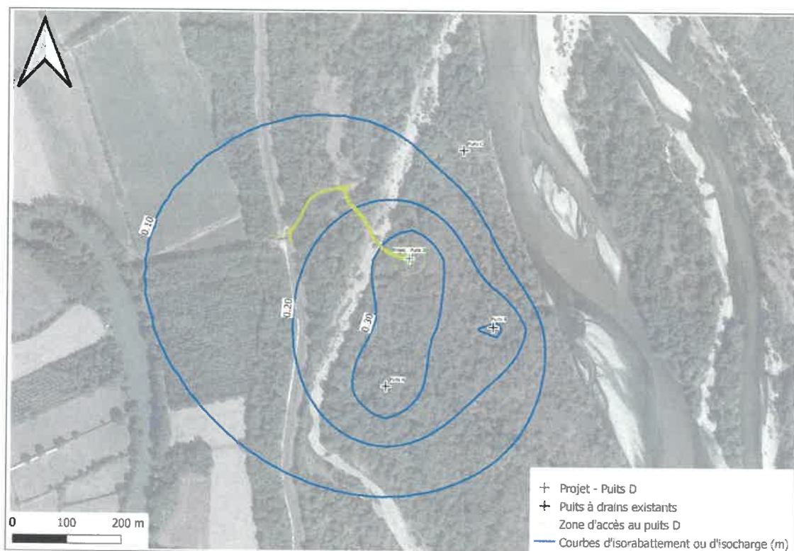
Figure 71 : Simulation du rabattement de la nappe alluviale – Incidence du rabattement de la nappe lors de l'exploitation du champ captant (puits A, B et D) en période d'étiage
