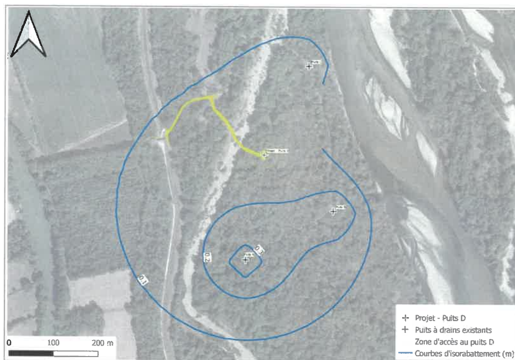
Figure 68 : Simulation du rabattement de la nappe alluviale – Incidence de l'exploitation du champ captant en période d'étiage
