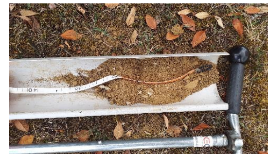
Sol indéterminé qui correspond aux sondages 1 et 7
