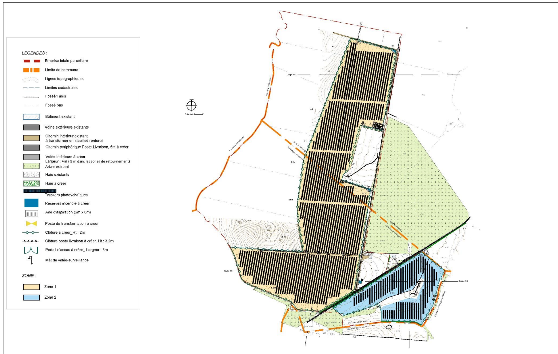
Figure 2 - Plan de masse - Implantation des panneaux photovoltaïques
