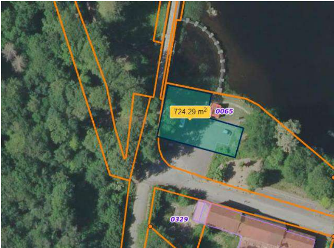
Figure 11 : Zone d'installations de chantier
